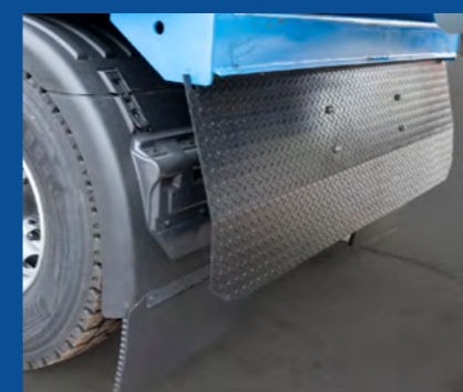
OSŁONA RAMY I NADKOLI WZMACNIANA BLACHĄ ŁĘŻKOWĄ O GRUBOŚCI 4 MM
